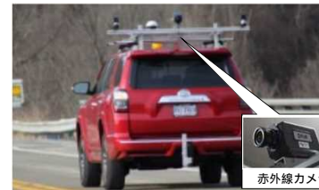
<赤外線カメラによる コンクリート床版の撮影>
