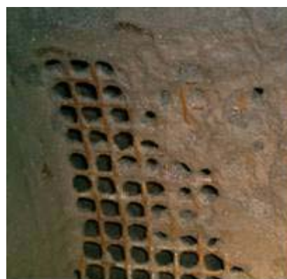
写真 - 6.1 加熱実験後のトロンメルの状況(左：加熱温度 160 ，右：加熱温度 140 )
