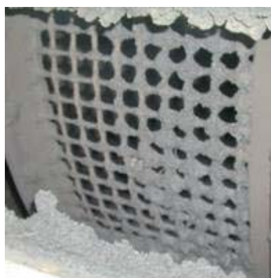
写真 - 6.1 加熱実験後のトロンメルの状況(左：加熱温度 160 ，右：加熱温度 140 )
