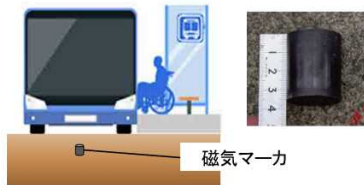
磁気マーカーを活用した 自車位置補正による運行の補助
