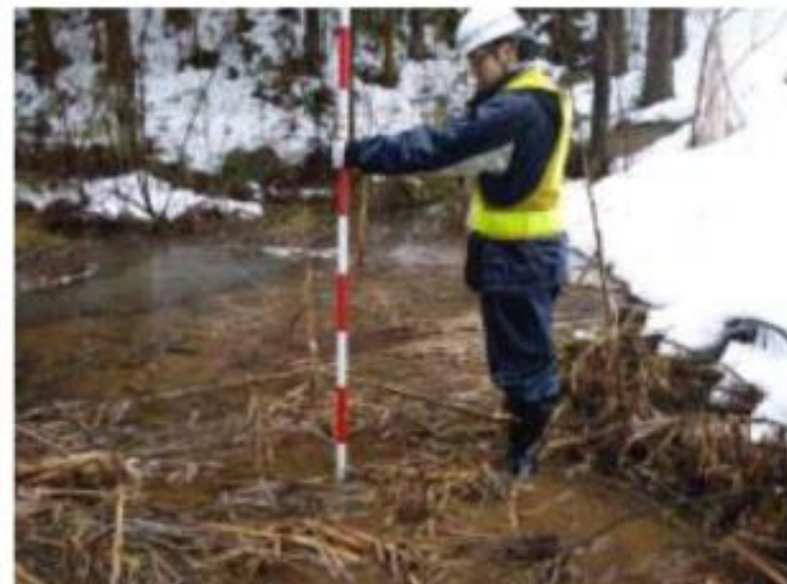
P4 法尻付近 下り車線側 (排水溜まりとなっている 旧水田は湿地状)
