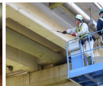
▲コンクリートのうき・はく離を非破壊で検査する技術
