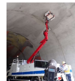
レーザー打音による変状の把握
