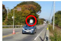
車載装置による路面性状測定
