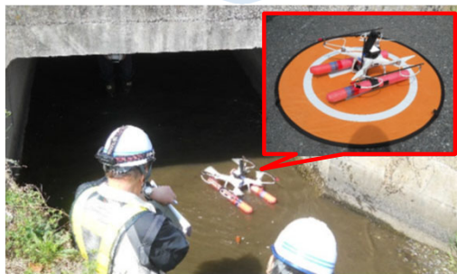
ボート型ロボットカメラによる画像計測
