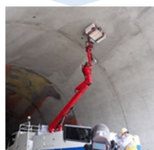
レーザー打音による変状の把握
