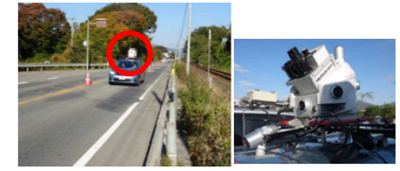
車載装置による路面性状測定
