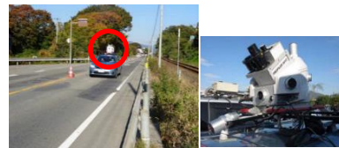
車載装置による路面性状測定
