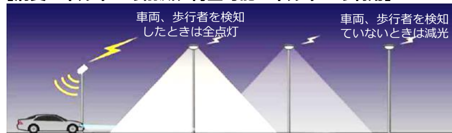
<センシング技術を活用し、車両検知時のみ点灯する照明の高度化イメージ>
