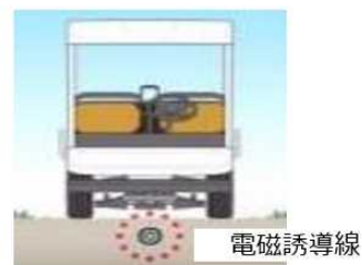
(a)電磁誘導線による自車位置特定による運行の補助
