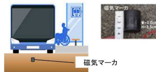
(b)磁気マーカによる自車位置特定による運行の補助
