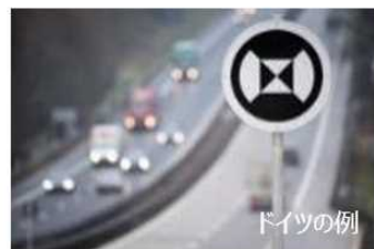
(c)位置情報表示施設による自己位置補正の補助
