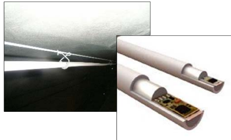
※半導体を利用した火点検出装置の例
