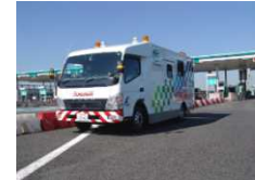
<路面性状測定車による点検>
