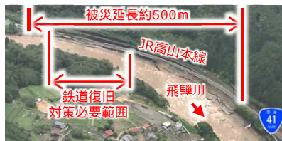
<護岸洗掘による国道41号の被災状況> <JR高山本線擁壁部分補強工事>
