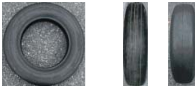
写真 - 3 PIARC 標準タイヤ / 正前、側面（リブ付き、平滑）
